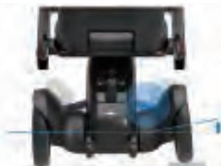
左右のモーターを適切に制御することで、横に傾斜した道でもまっすぐ走ることができます。
